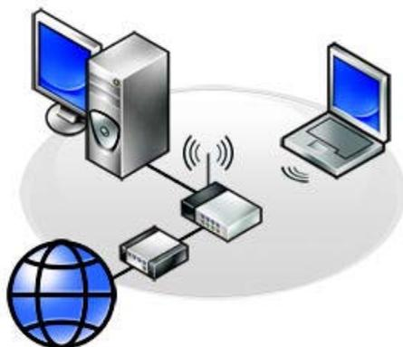
Os dispositivos são conectados sem o uso de cabos e cobrem uma área relativamente pequena, geralmente dentro de uma casa ou de um edifício. A conexão sem fio usada para configurar a WLAN é geralmente Wi-Fi (802.11x).
